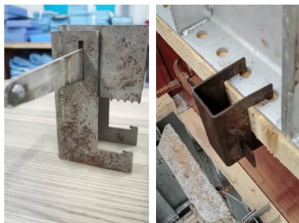
图5 锯齿卡槽式紧固装置
